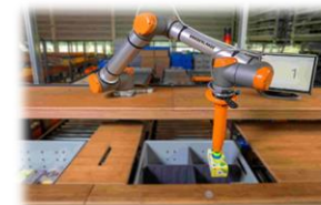
ピッキング ロボット
